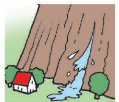
斜面から水がふき出す
